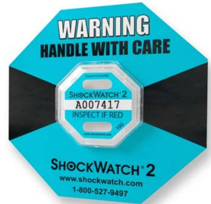
Das Auslöseverhalten des **ShockWatch® 2** ist primär für die vertikale (senkrechte) Stoßachse definiert. Eine Auslösung bzw. Verfärbung des **ShockWatch® 2** erfolgt im Stoß-Winkelbereich zwischen 45° und 90° zum Boden. Die Anbringung hat so zu erfolgen, dass die beiden Indikatorfenster jeweils oben und unten sind.
